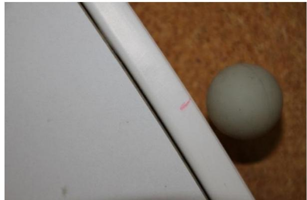
Daher untersuchten wir Stellen, die noch weiter oben auf der Bahn lagen. Bei einem Wert  $0,755m$  über dem Nullniveau war die Kugel, wie an den Bildern ersichtlich wird, noch nicht abgehoben. Wir maßen dazu bei der Auswertung der Bilder am Computer ab, wie lang der noch in der Vertiefung liegende Teil der Kugel im bewegten und im ruhenden Zustand war. In diesem Fall ist auf beiden Bildern kein Unterschied feststellbar.
