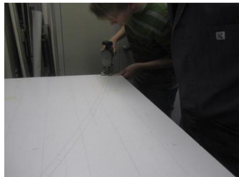
die Kugel auf der Bahn  $y(x) = x^3$  laufen soll, mussten wir die Punkte senkrecht zur jeweiligen Tangente der Bahn um 1.8cm nach außen verschieben. Mit einer Stichsäge und Schleifmaschine konnten wir somit eine Bahn konstruieren, welche stabil war und somit verlässlichere Ergebnisse produzieren sollte. Einen Teil der Kunststoffstange ließen wir am Anfang der Holzplatte überstehen, um diese in die Höhe biegen und so der Kugel eine Anfangsgeschwindigkeit  $v_0$  geben zu können.
