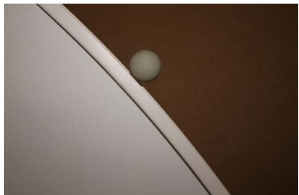
Als Grund für diese Abweichungen vermuten wir, dass die Kugel nur dann weitere Rotationsenergie aufnimmt, wenn sie stark genug auf den Untergrund gepresst wird. Wird sie nicht stark genug angepresst, erhöht sich bei der weiteren Bewegung nur noch ihre Translationsenergie. Die Kugel wird dadurch stärker beschleunigt und hebt früher ab.
